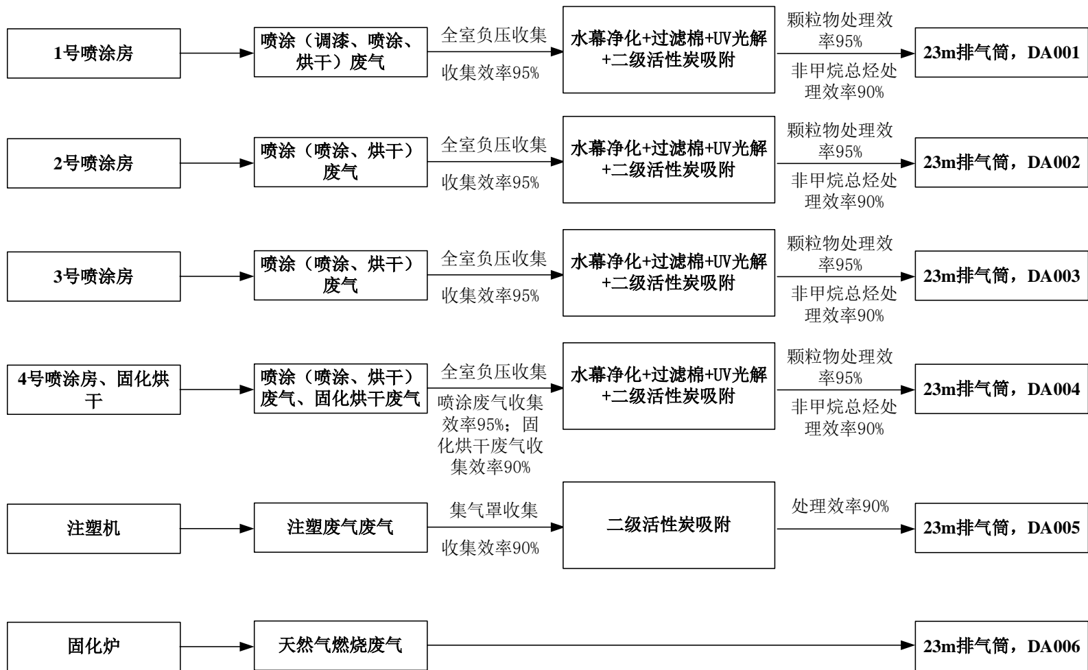
图 4-1 本项目有组织废气收集、处置、排放示意图
